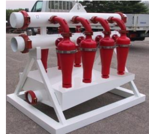
Desilter a 7 idrocycloni da 5"
