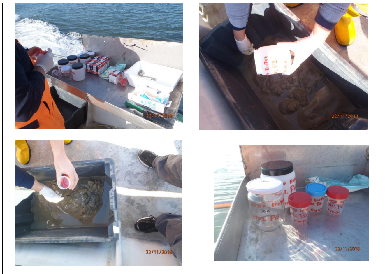
Fig. 09 – Sequenza dell'attività di campionamento dei sedimenti
