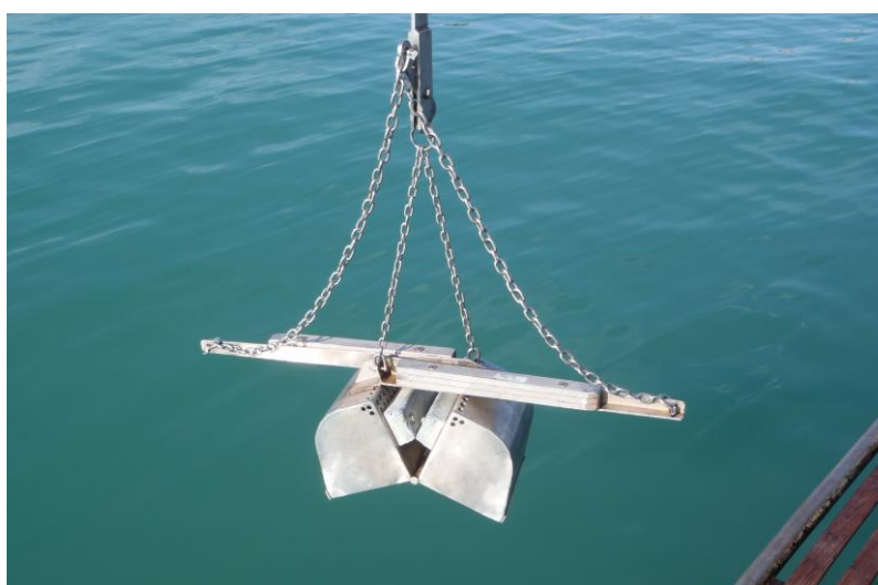
Fig. 08 – Benna Van-Veen per campionamento sedimenti
