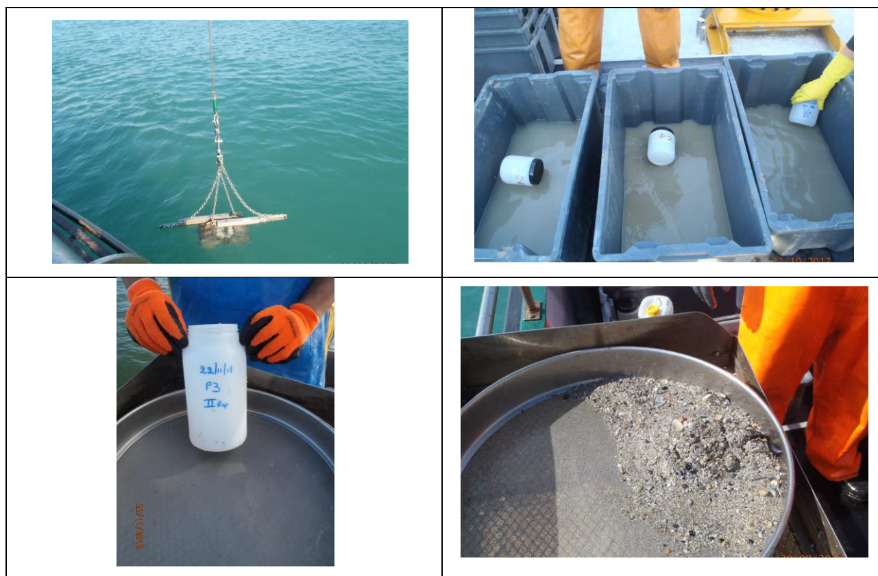
Fig. 10 – Sequenza di campionamento sedimento per caratterizzazione della popolazione bentonica
