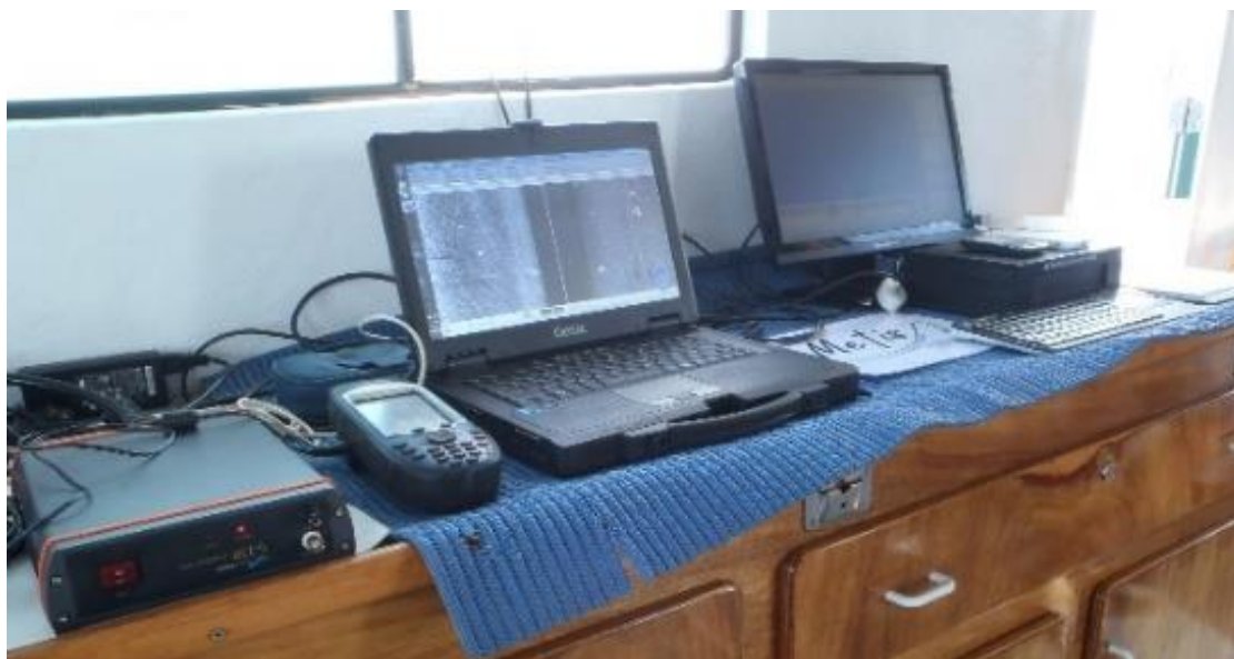
Fig. 16 – Workstation per acquisizione e registrazione dati SSS
