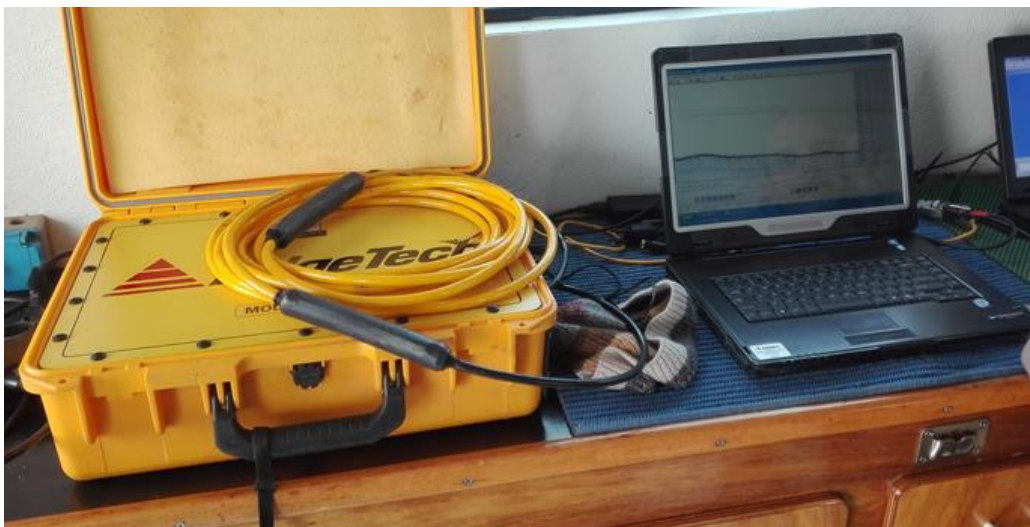
Fig. 24– Unità Hardware per acquisizione e registrazione dati
