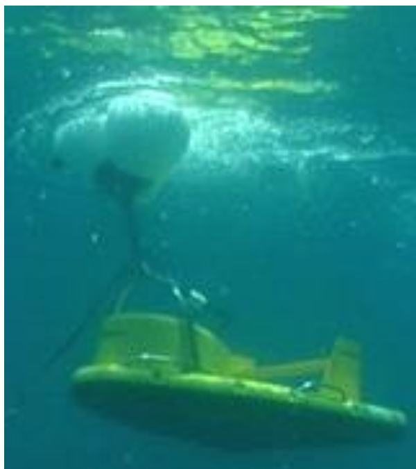
Fig.25 –Towfish SBP in immersione e trainato dall'imbarcazione
