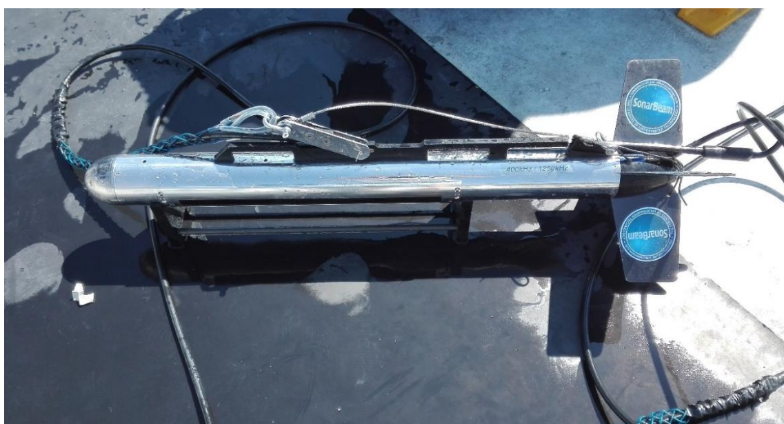
Fig. 17 - Towfish del sistema SSS ad alta frequenza
