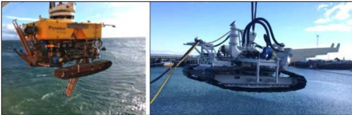
*Figura 6-26 Esempio di macchina per jetting su cingolato*
