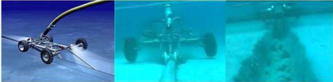
*Figura 6-25 Esempio di macchina per jetting autopropulse*
