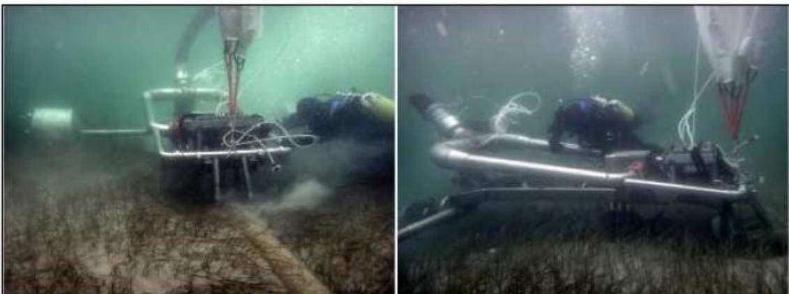
Figura 6-28 Esempio di macchina per il jetting su Posidonia oceanica su sabbia
