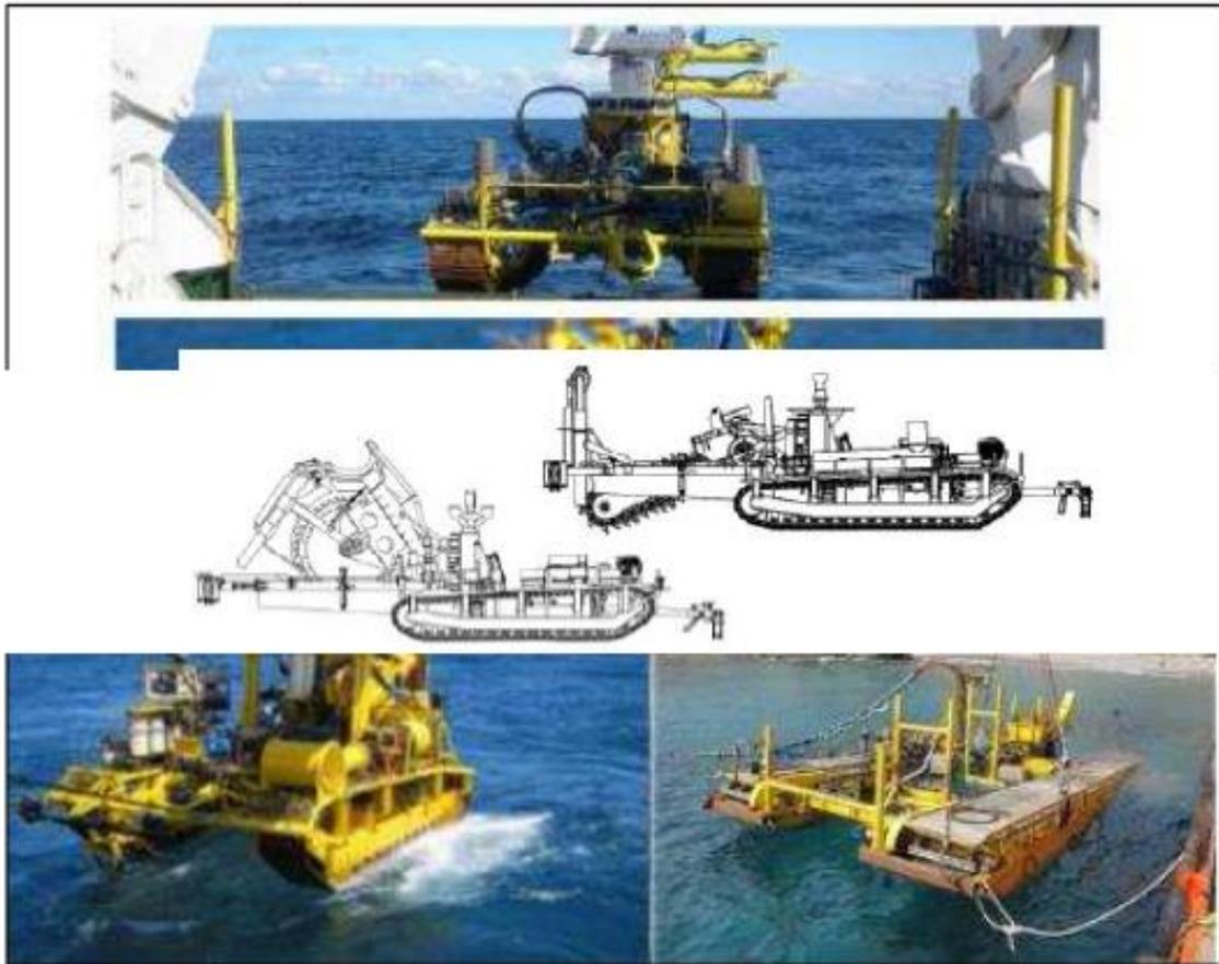
*Figura 6-30 Esempio di macchina per il trenching convenzionale*
