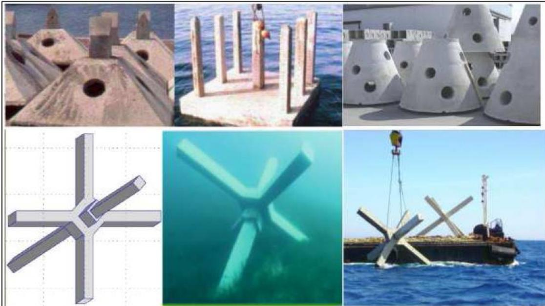
Figura 6-41 Esempio di dissuasori a protezione del cavo marino
