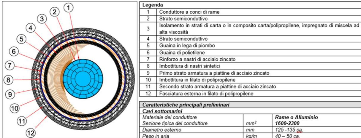
Figura 5-11 Dimensioni e caratteristiche dei cavi di polo
