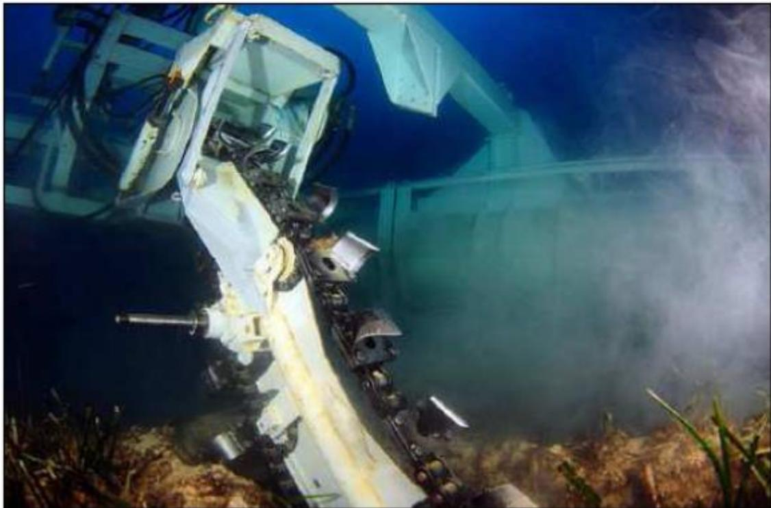
*Figura 6-33 Esempio di utensile di taglio per una macchina per il trenching*
