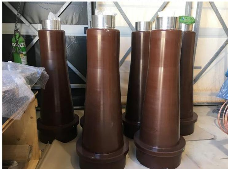
*Figura 6-16 Particolare terminale cavo*
