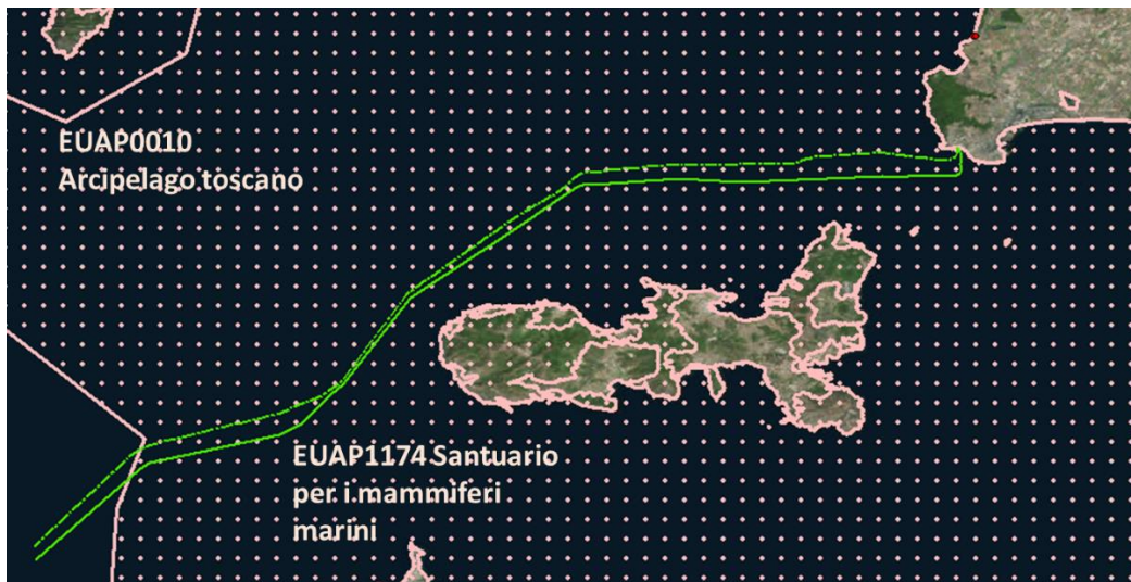
Figura 1-46: EUAP 1174 “Santuario per i mammiferi marini” e EUAP0010 “Arcipelago toscano” in relazione al tracciato D dei cavi marini in progetto e al limite delle acque del territorio italiano. Linea celeste: limite acque territoriali. In verde: cavi marini in progetto
