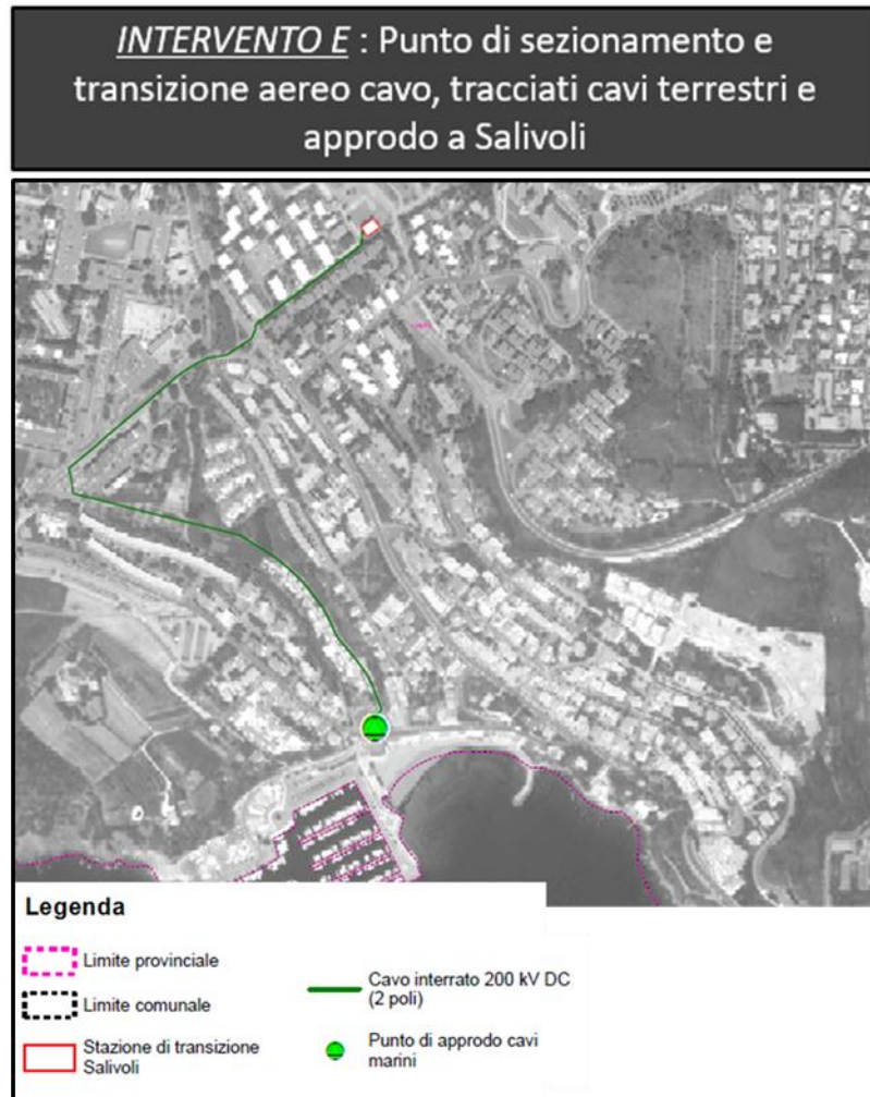
Figura 6-5: Intervento E - Punto di sezionamento e transizione aereo cavo, tracciato cavi terrestri e approdo a Salivoli – interventi di progetto
