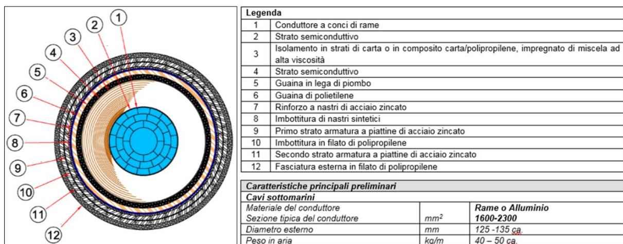
Figura 2-11 Dimensioni e caratteristiche dei cavi di polo
