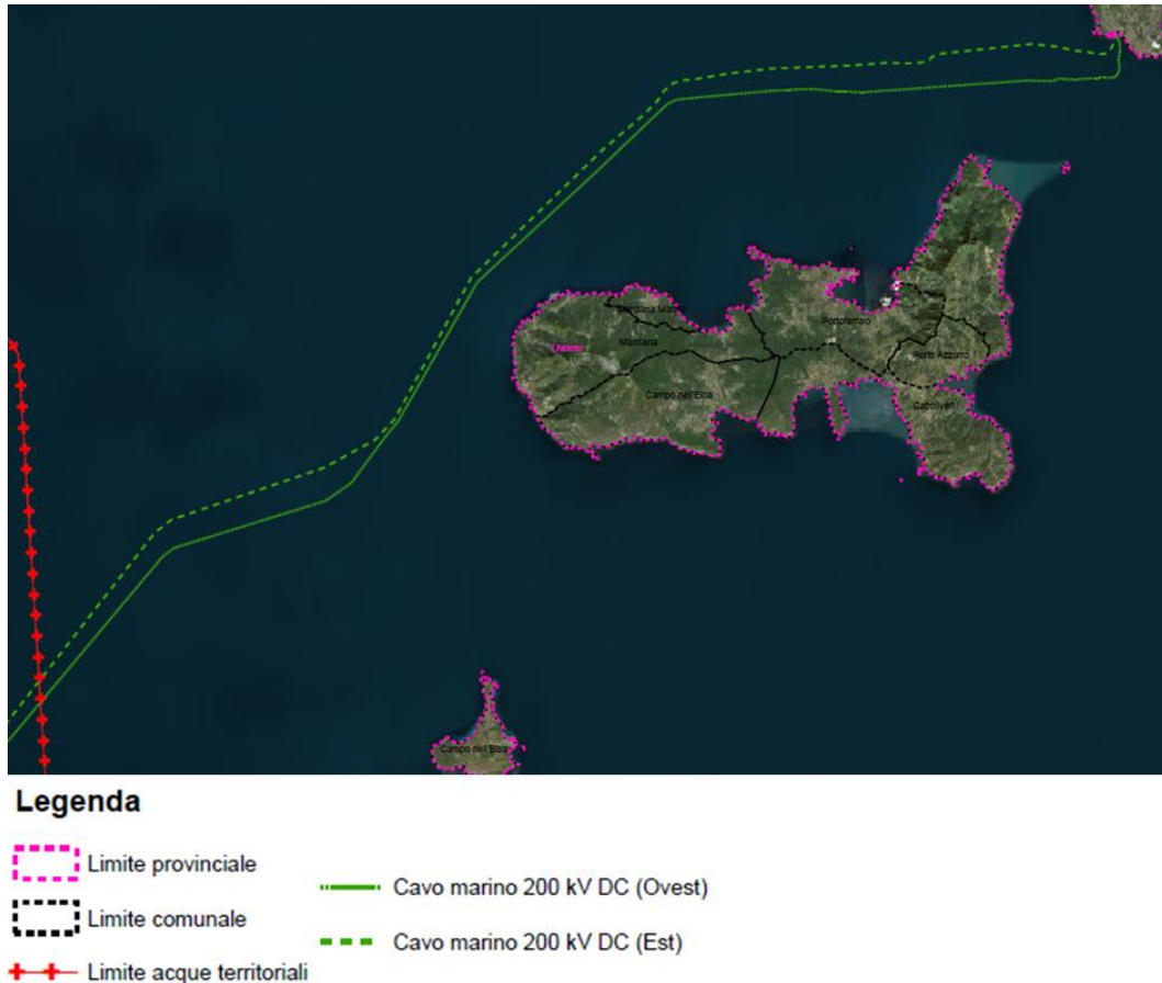
Figura 2-12 Intervento D: Tracciato cavi marini dal confine delle acque territoriali a Salivoli
