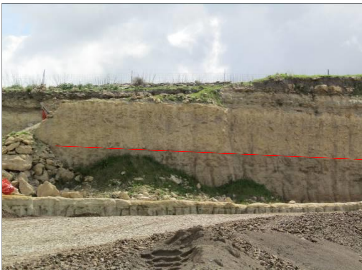
Limite stratigrafico evidenziato in rosso tra i calcari marnosi e le sabbie sottostanti lungo uno scavo nelle vicinanze dell'area d'indagine
