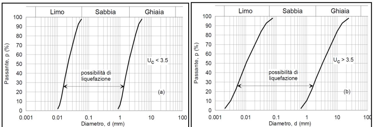
Fig. 7.11.1. Fusi granulometrici di terreni suscettibili alla liquefazione
