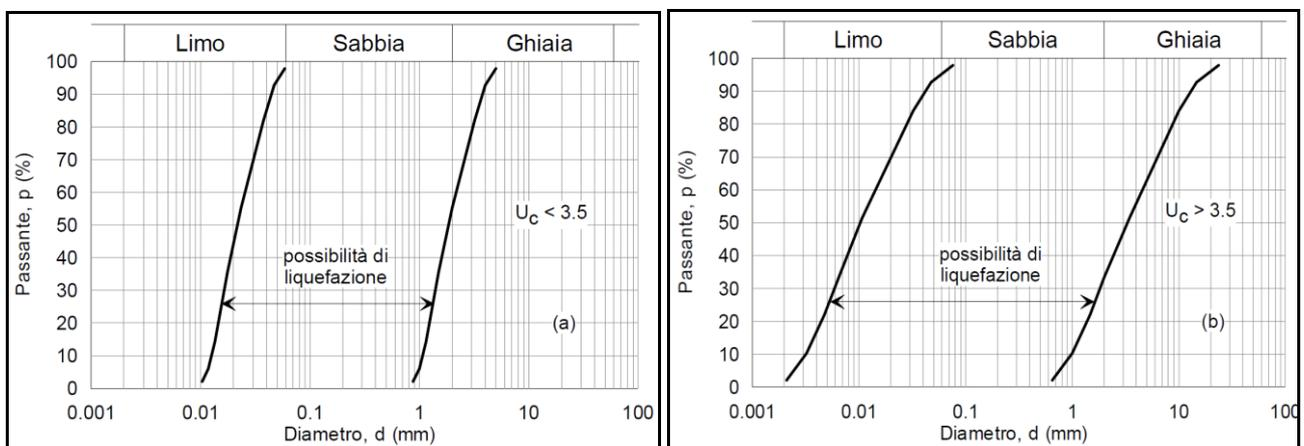
Fig. 7.11.1. Fusi granulometrici di terreni suscettibili alla liquefazione
