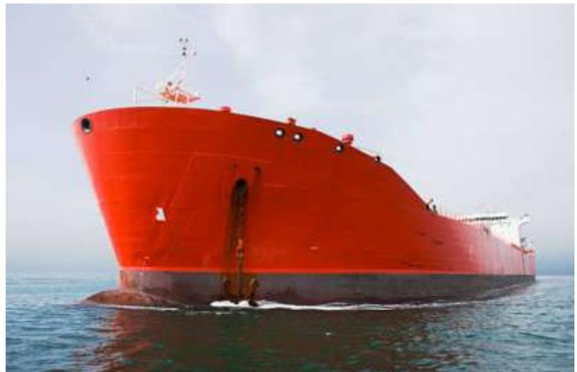
**Figura 2-3 – Ancora salpata o filata dall'occhio di cubia della nave**
