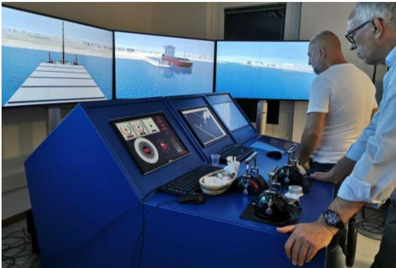
*Figura 2-5 Simulatore SAND – Scenario 3D (Imboccatura e accosto Terminal IVI)*
