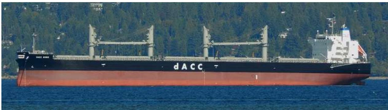
Figura 4-2 Nave bulk carrier – immagine rappresentativa dell'opera morta
