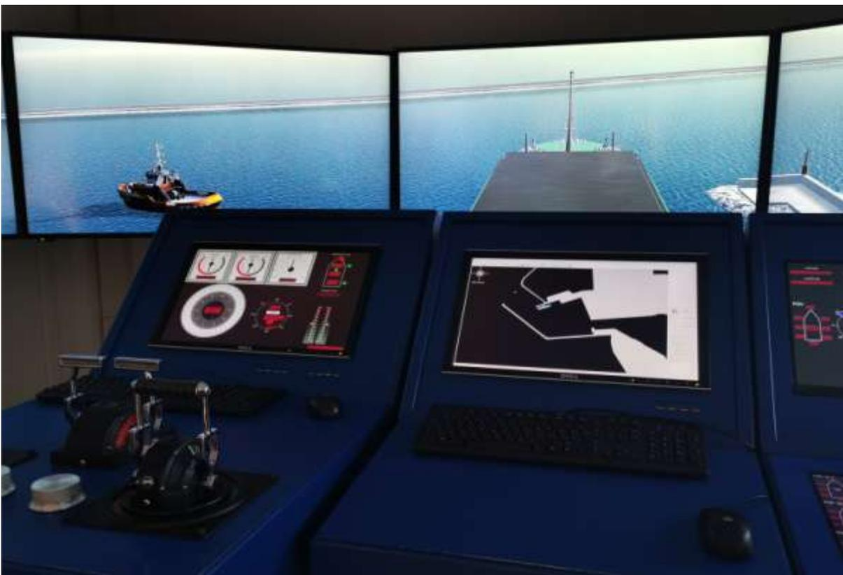
**Fig. B 10 – Simulatore SAND, scenario 3D**
