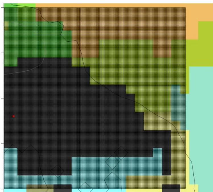
Figura 5.3: Grigliato orizzontale del dominio della simulazione di dispersione, nel caso con flusso da mare. Il punto rosso indica la posizione del centro geometrico della sorgente (vaporizzatori GNL)
