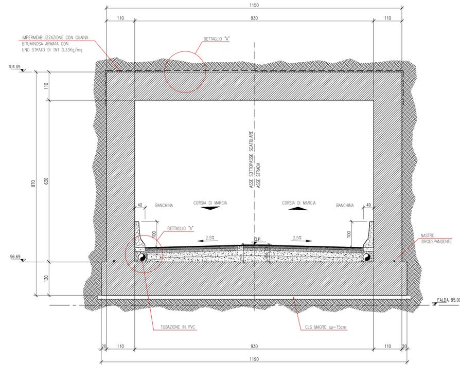
**SEZIONE CORRENTE PARAPETTO CON PARIPEDE**
