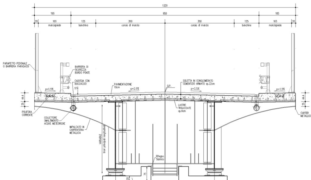
Figura 1 – Sezione trasversale impalcato
