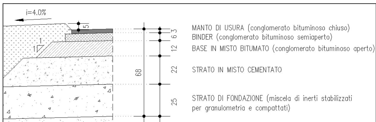
Sull'opera d'arte si prevede una sovrastruttura stradale in conglomerato bituminoso di spessore pari a 10 cm comprensivo dell'impermeabilizzazione (pari ad 1 cm).
