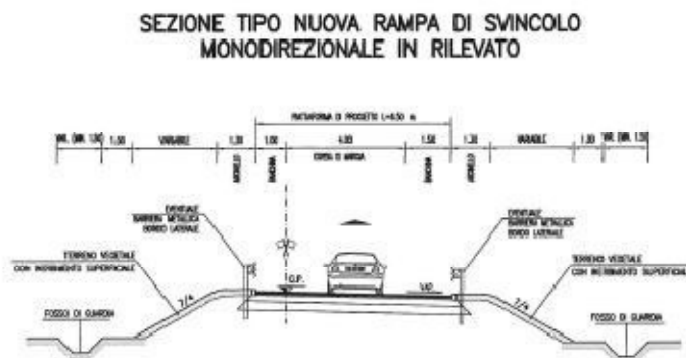
Fig. 9-4: sezione tipo rampa di svincolo monodirezionale
