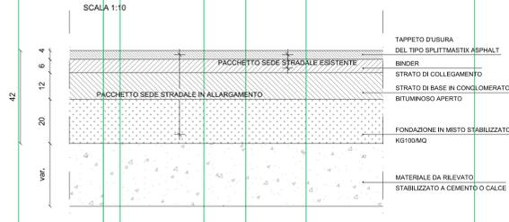
**SEZIONE TIPO B-B - ROTATORIA**
