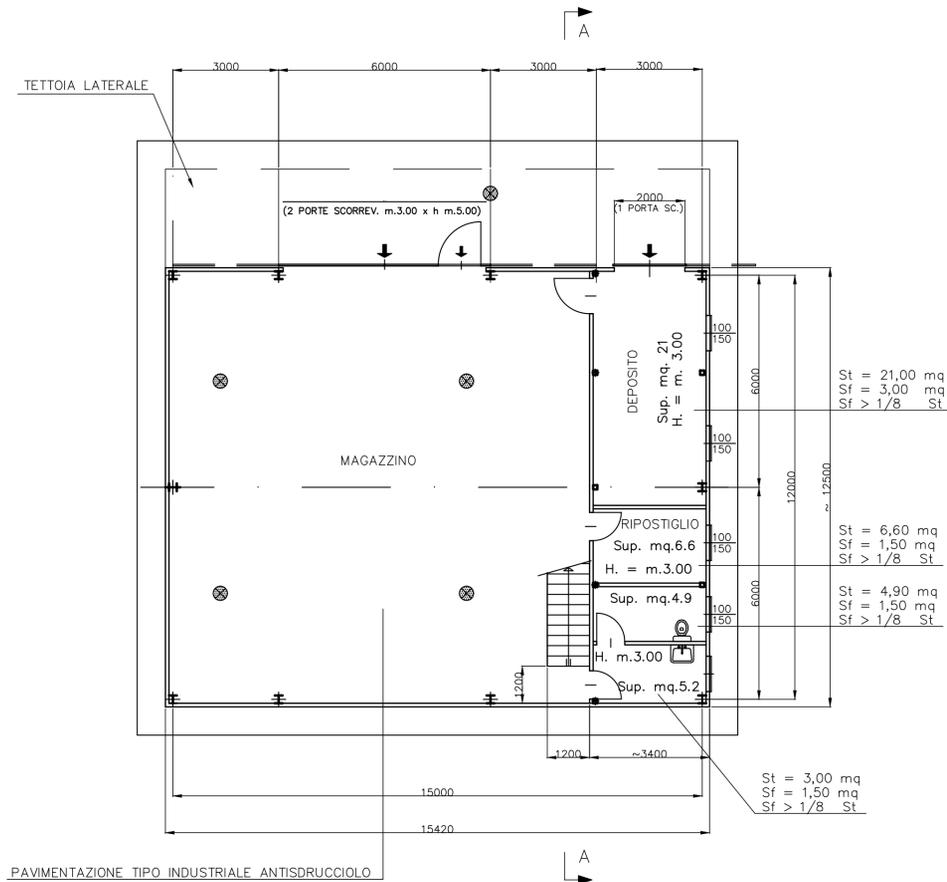
PIANTA PIANO UFFICIO-MAGAZZINO
