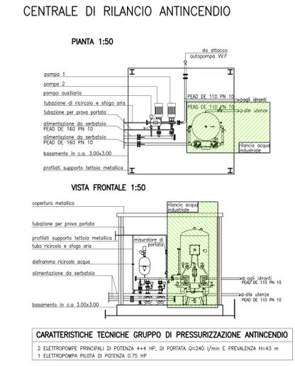
STAZIONE DI PRESSURIZZAZIONE ANTINCENDIO: SCHEMA IDRAULICO
