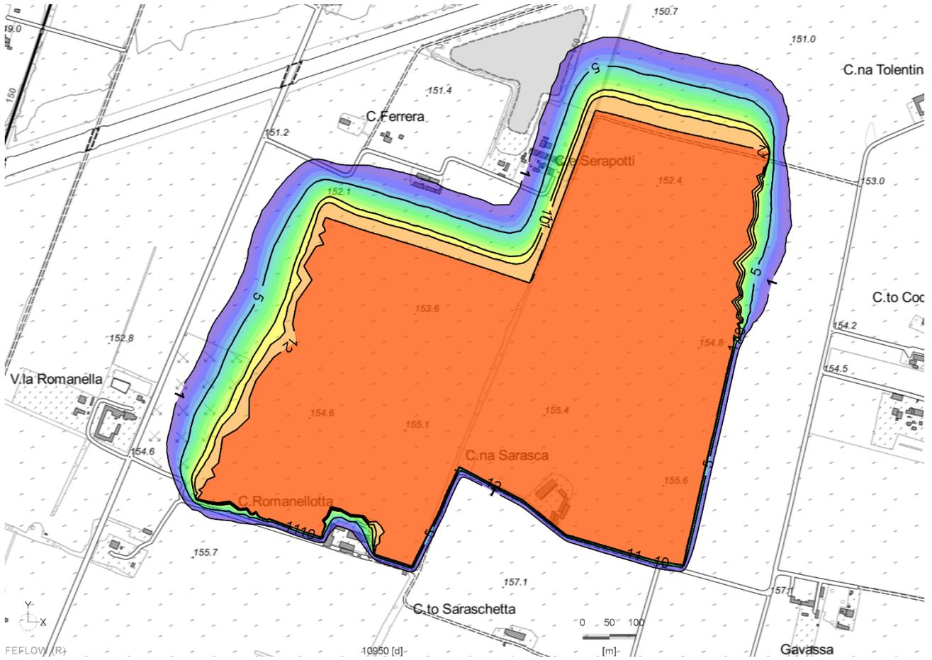
Figura 35 – Previsione di diffusione del Nichel per lo Scenario 1: visualizzazione alla scala di dettaglio delle isolinee di concentrazione dell'eluato dopo 30 anni dall'abbancamento del deposito.
