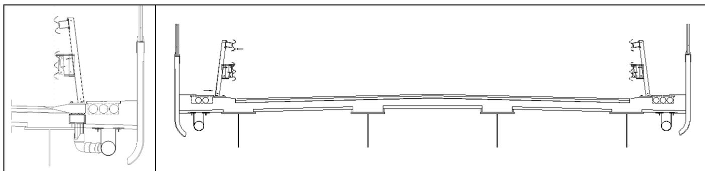
*Figura 3: sezione tipo smaltimento acque su viadotto.*
