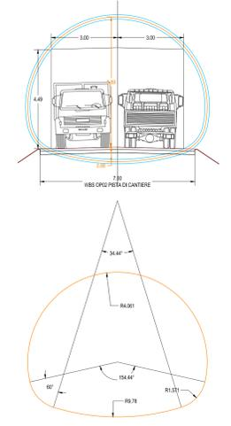
Al termine della carverizzazione e a dismissione della pista di cantiere WBS ORIZ la tubazione autoportante ondulata sarà oggetto di riempimento in cemento e sagomata nella parte esterna al rilevato della rampa R1K.
