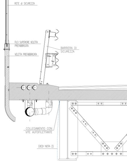
(NOTA 2): COLLEGAMENTO A TERRA MEDIANTE PICCHETTO VERTICALE DI LUNGHEZZA PARI A 1,5m CON SEZIONE A CROCE 50x60x6mm in ACCIAIO ZINCATO A CALDO PER IMMERSIONE DOPO LAVORAZIONE, POSTO ad 1m dalla PROIEZIONE IN PIANTELLA DELLA FONDAZIONE DEL PIASTRINO
