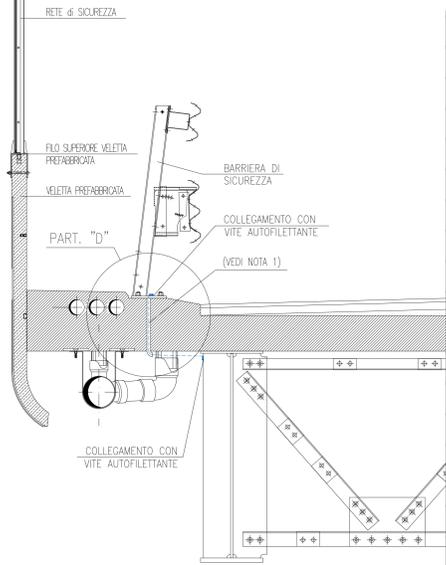
(NOTA 1): TUBO in PVC Ø30 per COLLEGAMENTO tra BARRIERA DI SICUREZZA e IMPALCATO REALIZZATO MEDIANTE CORDA d'ACCIAIO ZINCATO 50mm<sup>2</sup> con TERMINALI in RAME STAGNATO
