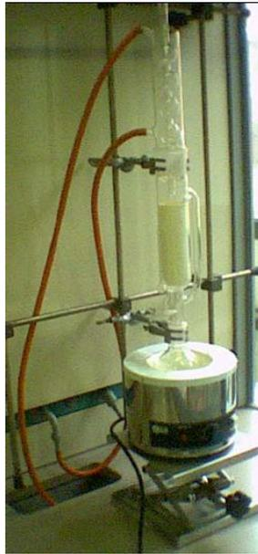
**Materiale:** Apparato elevatore, isomantello, pallone da 250 ml, un apparato di Soxhlet con refrigerante apposito, un ditale di carta, pinze e morsetti, due tubi di gomma, moderatore di ebollizione (sfere di pyrex), cilindro graduato da 250 ml, solvente organico d'estrazione, cilindretto graduato da 10 ml, pipette Pasteur, cristallizzatore, piastra riscaldante, ancoretta magnetica, imbuto, tettarelle, cotone, provetta o protettone da 250 ml.
