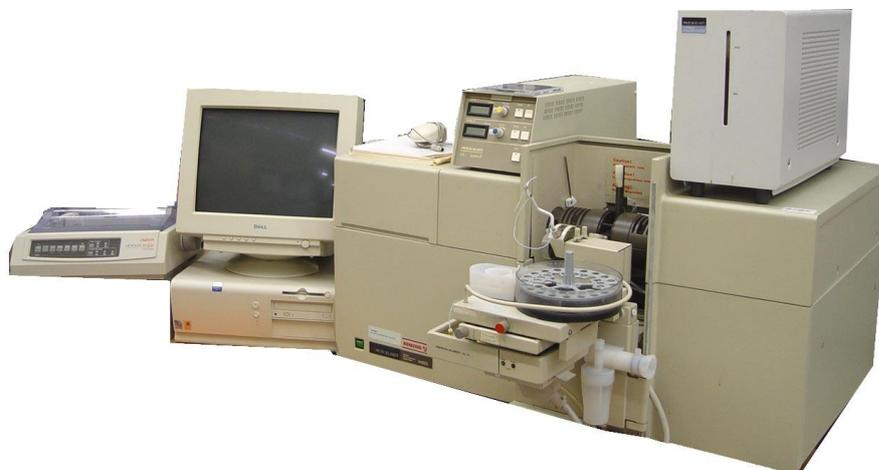
TIPO DI STRUMENTO: Spettrofotometro ad assorbimento atomico a doppio raggio con correttore di fondo Zeeman 4100 Z.
