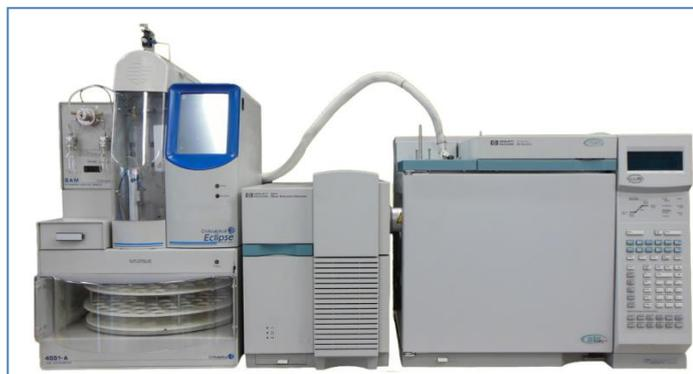
**A1- IX Analisi Glicole etilenico e Idrocarburi totali - Gascromatografo GC FISON'S INST.**
