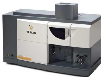
Spettrofotometro ad emissione atomica al plasma ad accoppiamento induttivo (ICP) e lettura sequenziale. Il sistema di raccolta della radiazione emessa dal plasma è di tipo assiale. Il generatore di radiofrequenze è 40 MHz. Per il raffreddamento del plasma viene impiegato argon ultrapuro.
