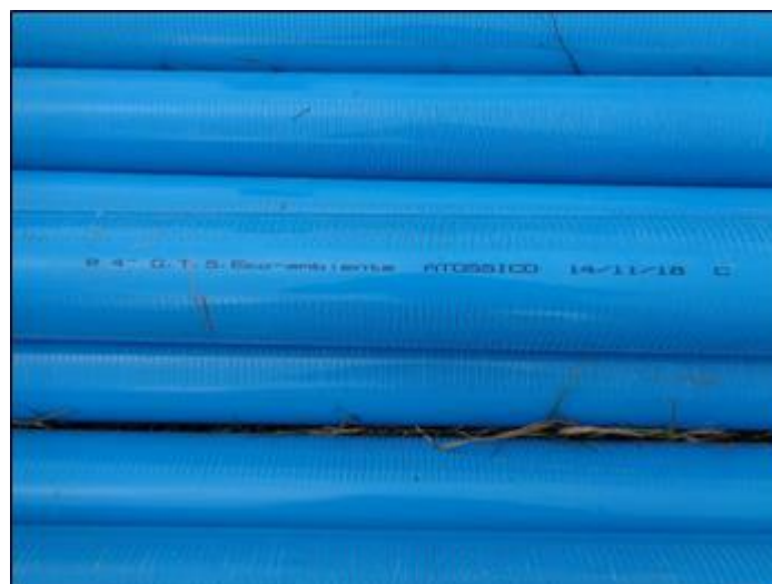
Figura 3 – Tubazione in PVC microfessurata utilizzata
