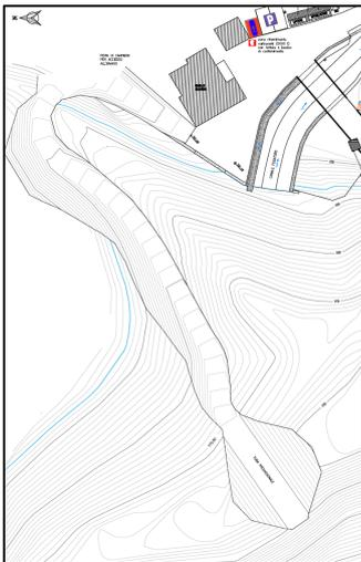
Infine, per consentire l'accesso all'invaso, sarà anche realizzata a monte della diga una pista di cantiere temporanea, che nella fase iniziale sarà sfruttata per l'esecuzione di una tura provvisoria necessaria per impedire l'allagamento delle aree di lavoro in presenza di precipitazioni, e successivamente consentirà l'accesso dei mezzi d'opera e la realizzazione delle lavorazioni previste al piede del paramento di monte.
