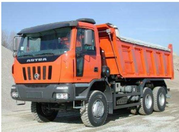
Figura 63: Veicolo tipo movimenti terra su rete viaria esistente da 12 m<sup>3</sup>
