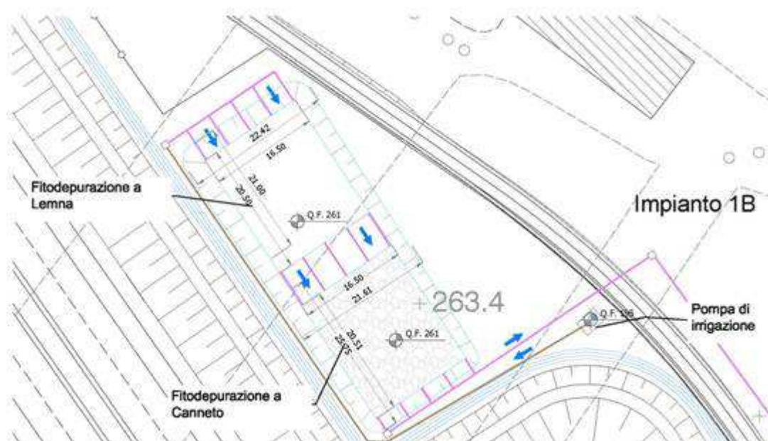
Posizione tipo delle pompe di irrigazione
