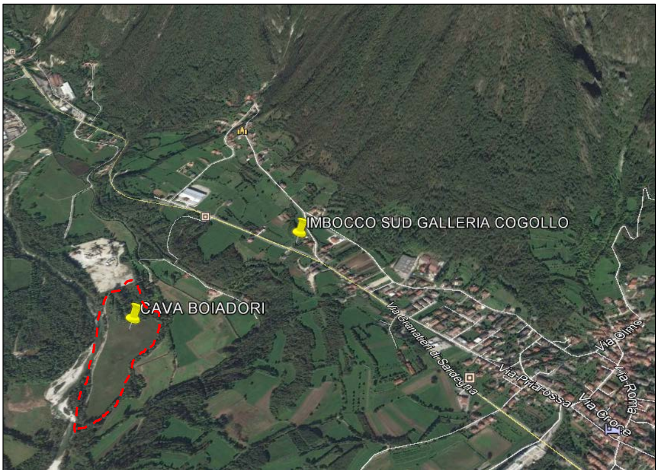
Figura 31 – Cava Bojadori per lo stoccaggio provvisorio delle terre e rocce da scavo e la lavorazione degli inerti
