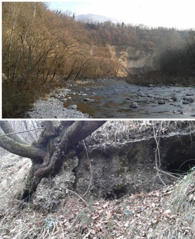
Figura 8 - Sequenza stratigrafica – Depositi fluvio-glaciali profondamente incisi dall’Astico in prossimità del viadotto Piovene (sopra). Orizzonte cementato affiorante in corrispondenza dell’orlo di un terrazzo a Cogollo del Cengio (sotto).
