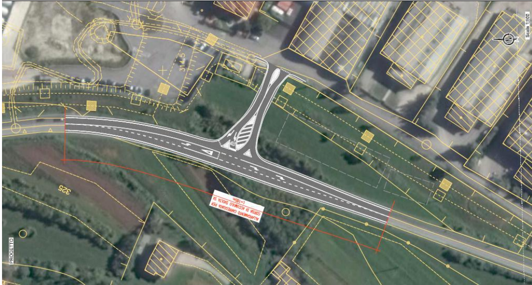
Figura: Soluzione di progetto per l’intervento 3
