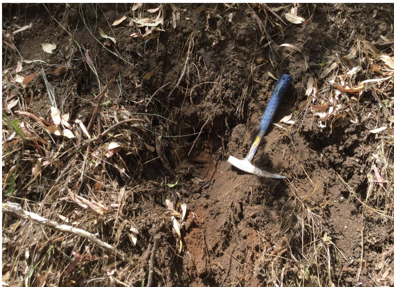
Foto 9 - Affioramento dei terreni sabbioso-limosa delle Coltri eluvio-colluviali (b2), nel comune di Campomarino, in sinistra del V.ne de Miglia.
