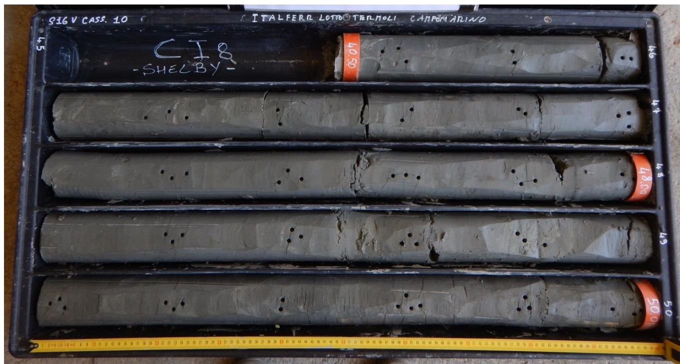
Foto 2 - Formazione delle Argille Subappennine (ASP) nel foro di sondaggio S16v, tra i 45.0 ed i 50.0 m dal p.c..
