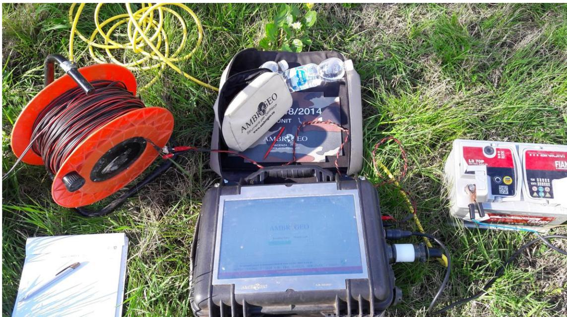
Figura 4: Sismografo digitale a 24 bit.
