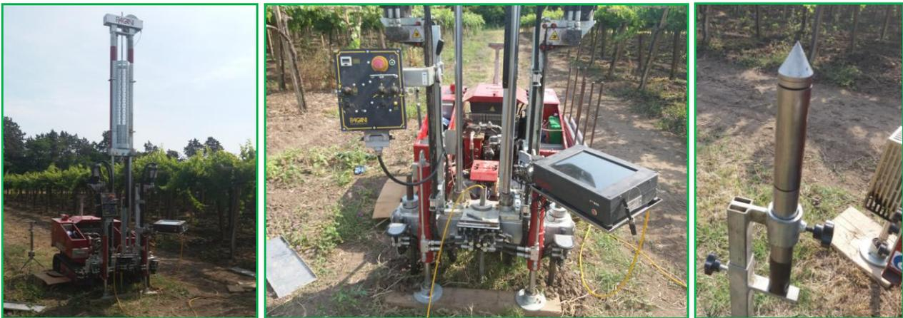
Foto 3.1 - Penetrometro con piezocono utilizzato.
