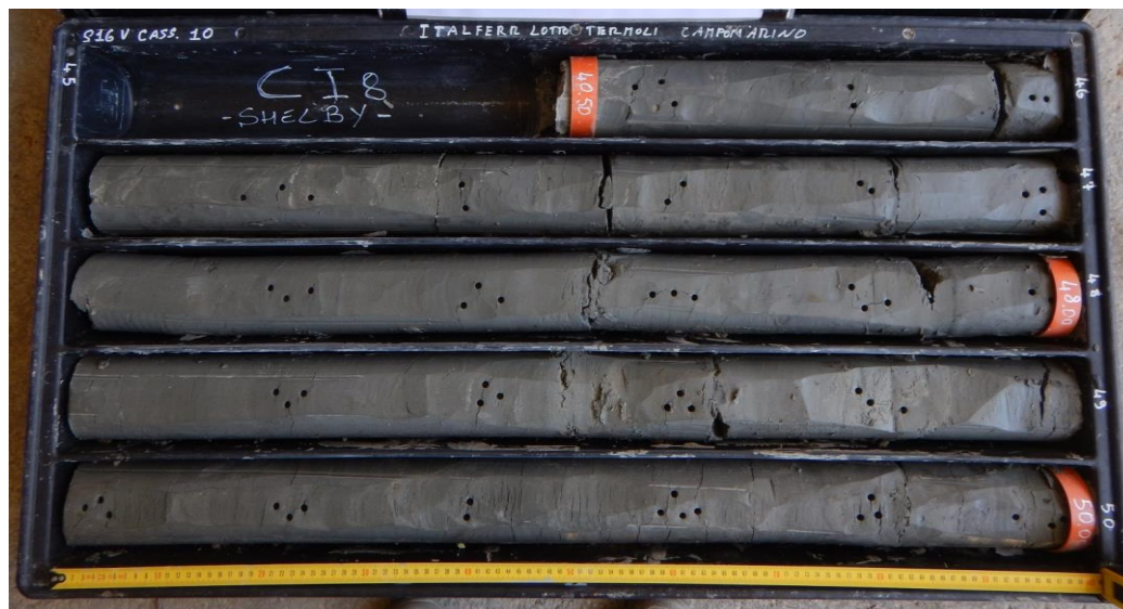
Figura 2 - Formazione delle Argille Subappenniniche (ASP) nel foro di sondaggio S16v, tra i 45 ed i 50 m dal p.c..
