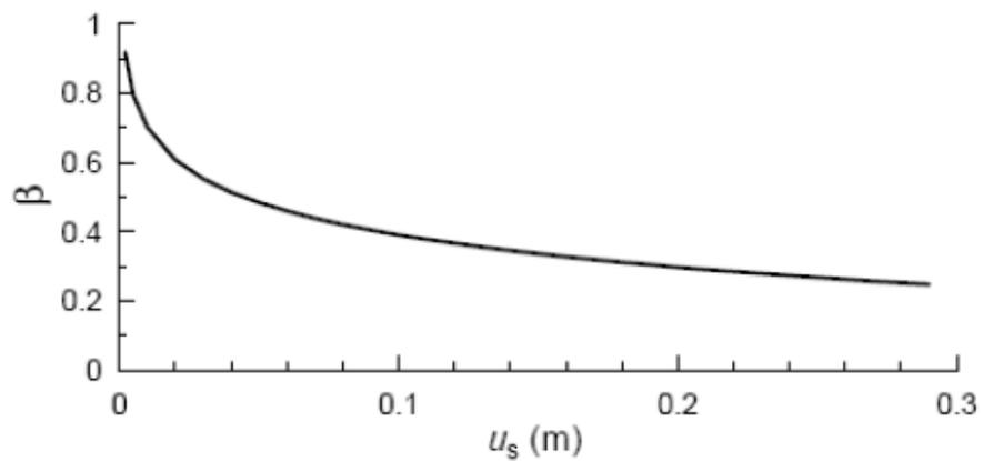
Figura 4: Figura 7.11.III delle N.T.C. 2008, da utilizzare per trovare il coefficiente  $\beta$ .
