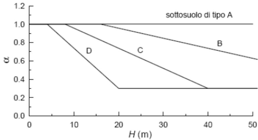
Figura 3: Figura 7.11.II delle N.T.C. 2008, da utilizzare per trovare il coefficiente  $\alpha$ .
