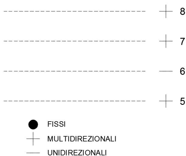
Figura 10 – Schema di appoggi travi a cassoncino in c.a.p.
