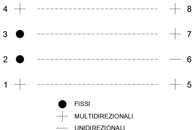
Figura 8 – Schema di appoggi travi a cassoncino in c.a.p.
