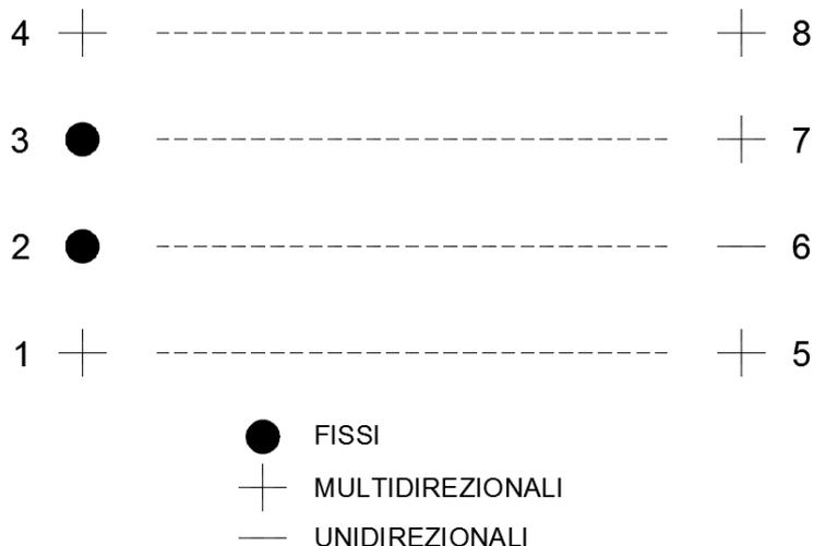
Figura 9 – Schema di appoggi impalcato c.a.p./acciaio-clc
