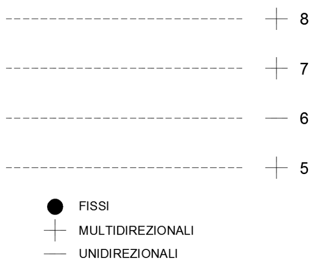
Figura 11 – Schema di appoggi travi a cassoncino in c.a.p.
