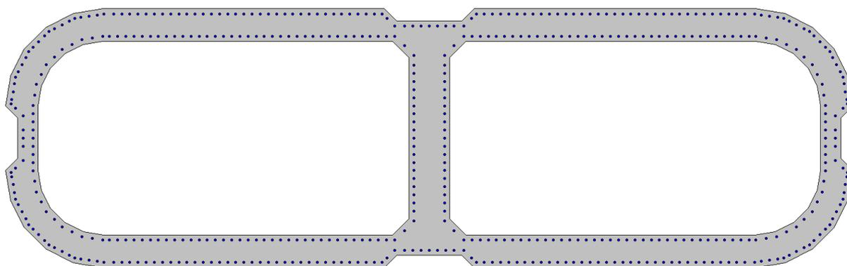
Figura 11 - Sezione trasversale base pila e relativa armatura
