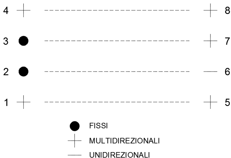
Figura 9 – Schema di appoggi travi a cassoncino in c.a.p.
