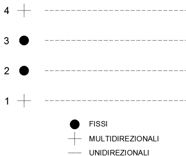
Figura 11 – Schema di appoggi travi a cassoncino in c.a.p.
