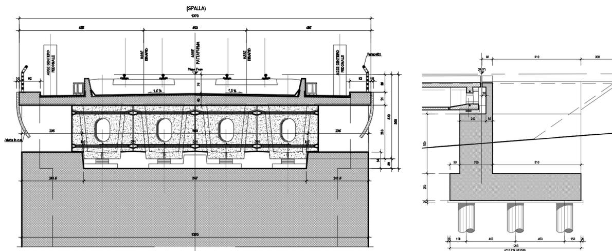
Figura 3 – Sezioni in direzione longitudinale e trasversale
