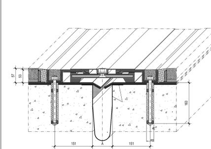
NOTA: LE CARATTERISTICHE DI RESILIENZA DI TUTTI I MATERIALI METALLICI ADOTTATI DOVRANNO ESSERE COMPATIBILI CON LA TEMPERATURA MINIMA DI ESERCIZIO DELL'IMPALCATO.
