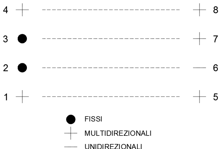
Figura 10 – Schema di appoggi travi a cassoncino in c.a.p.
