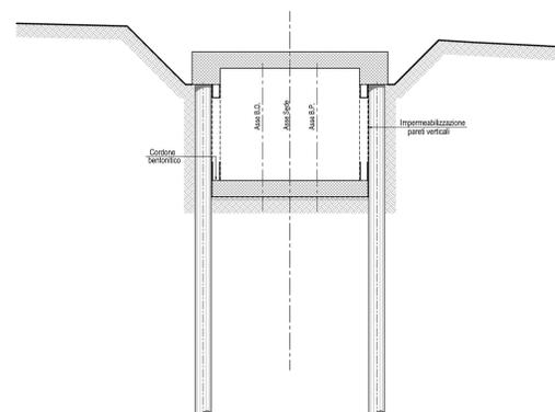
Fase 6: Posa della impermeabilizzazione sulle pareti verticali e dei cordoni bentonitici in corrispondenza delle sezioni di attacco tra i solettoni e le pareti verticali;
