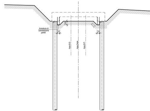
Fase 2: Scavo di ribasso per posa in opera delle armature di connessione del cordolo alle pareti verticali;
