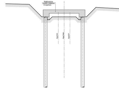
Fase 3: Realizzazione del cordolo testa pali e della soletta di copertura;
