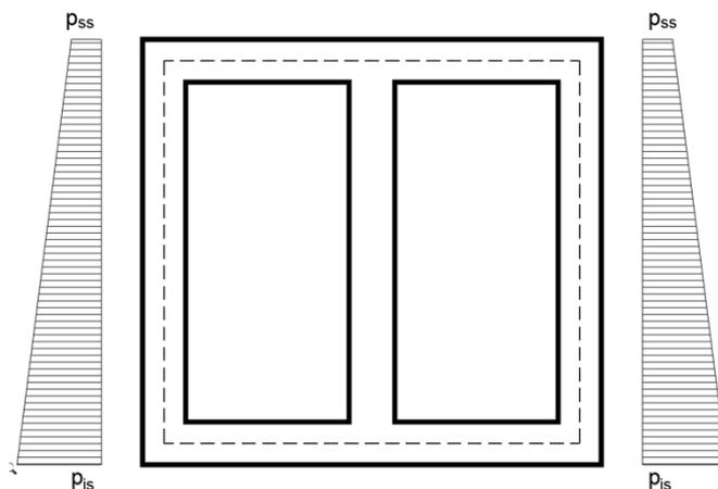
Per tenere in conto dei carichi agenti sul semispessore degli elementi considerati nel modello di calcolo, si applicano delle forze concentrate nei nodi tra piedritto e soletta superiore con valore pari a 5.81 kN ed inferiore con valore pari a 16.76 kN.
