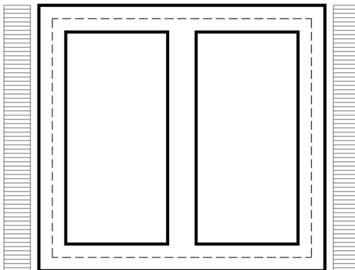
Per tenere in conto dei carichi agenti sul semispessore degli elementi considerati nel modello di calcolo, si applicano delle forze concentrate nei nodi tra piedritti e soletta superiore con valore pari a 8.76 kN ed inferiore con valore pari a 10.51 kN.
