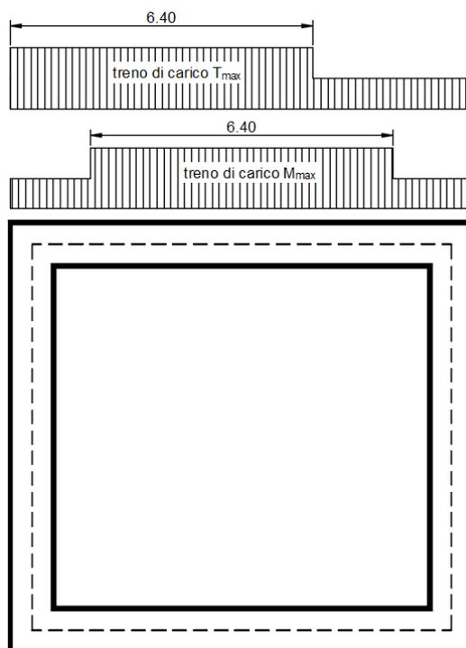
Per tenere in conto i carichi agenti sul semispessore degli elementi considerati nel modello di calcolo, si applicano delle forze concentrate nei nodi tra soletta superiore e piedritti con valore pari a 20.54 kN.
