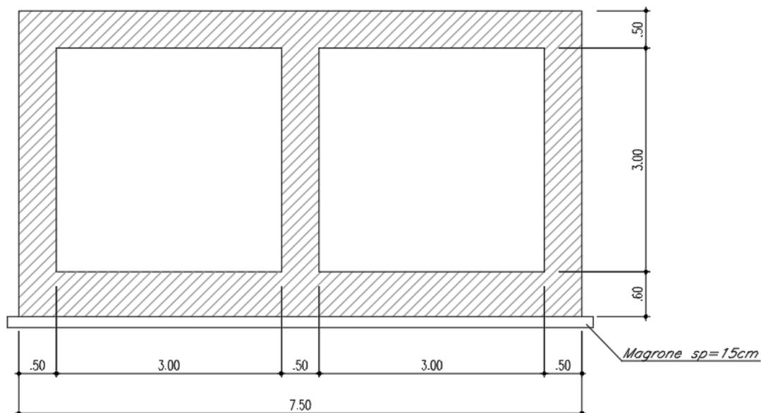
**Fig. 1 – Sezione trasversale dell'opera**
