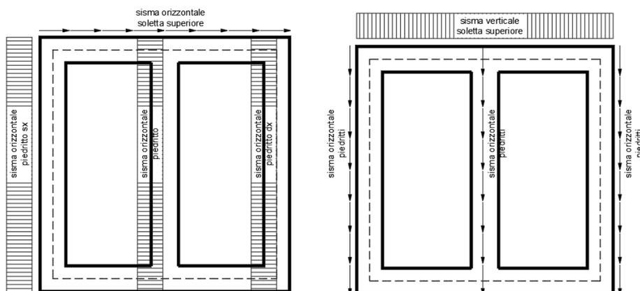
Per tenere in conto dei carichi agenti sul semispessore degli elementi considerati nel modello di calcolo, si applicano delle forze concentrate nei nodi tra piedritto e soletta superiore con valore pari a 8.76 kN ed inferiore con valore pari a 10.51 kN.
