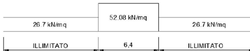
**Ai fini delle verifiche del carico equivalente si considera, in tutte le relazioni di calcolo specifiche, a favore di sicurezza, il carico equivalente ai 4 assi da 250 kN pari a 82.17 kN/m<sup>2</sup> a vantaggio di sicurezza rispetto ai 52.08 kN/m<sup>2</sup> calcolati con riferimento alle STI.**
