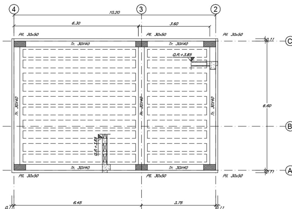
La parte in elevazione è costituita da travi e pilastri in c.a.. In particolare, i pilastri hanno dimensioni in pianta 0.30m x 0.50m, le travi perimetrali (trasversali e longitudinali) hanno dimensioni 0.30m x 0.40m e le travi interne hanno dimensione 0.30m x 0.40m.
