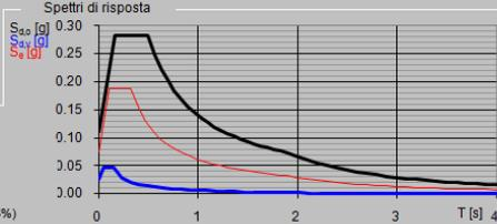
— Spettro di progetto - componente orizzontale
