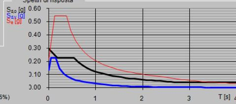
— Spettro di progetto - componente orizzontale
