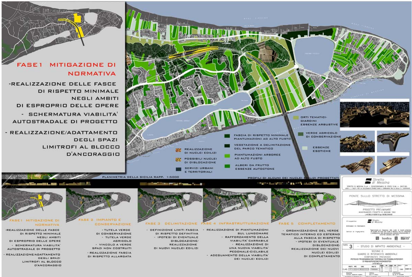
Figura 5.1 Il percorso di analisi della Componente paesaggio proposto dal Progetto Preliminare - Le fasi dalla mitigazione di progetto alla completa riorganizzazione del verde territoriale
