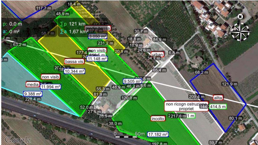
Esempio della immissione contestuale del grado di visibilità attraverso Measure Map Pro, con georeferenziazione dei dati, misurazione progressiva, tabelle esplicative e campiture colorate relative alla visibilità del terreno (Loc. Cianaluca, Campomarino)
