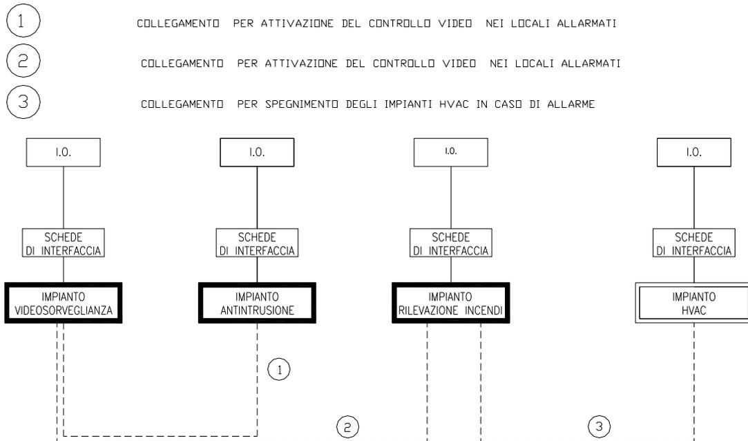
Per il collegamento con il sistema di supervisione la centrale TVCC dovrà essere dotata di apposita interfaccia e linguaggio di comunicazione basato su protocolli di comunicazione non proprietari.
